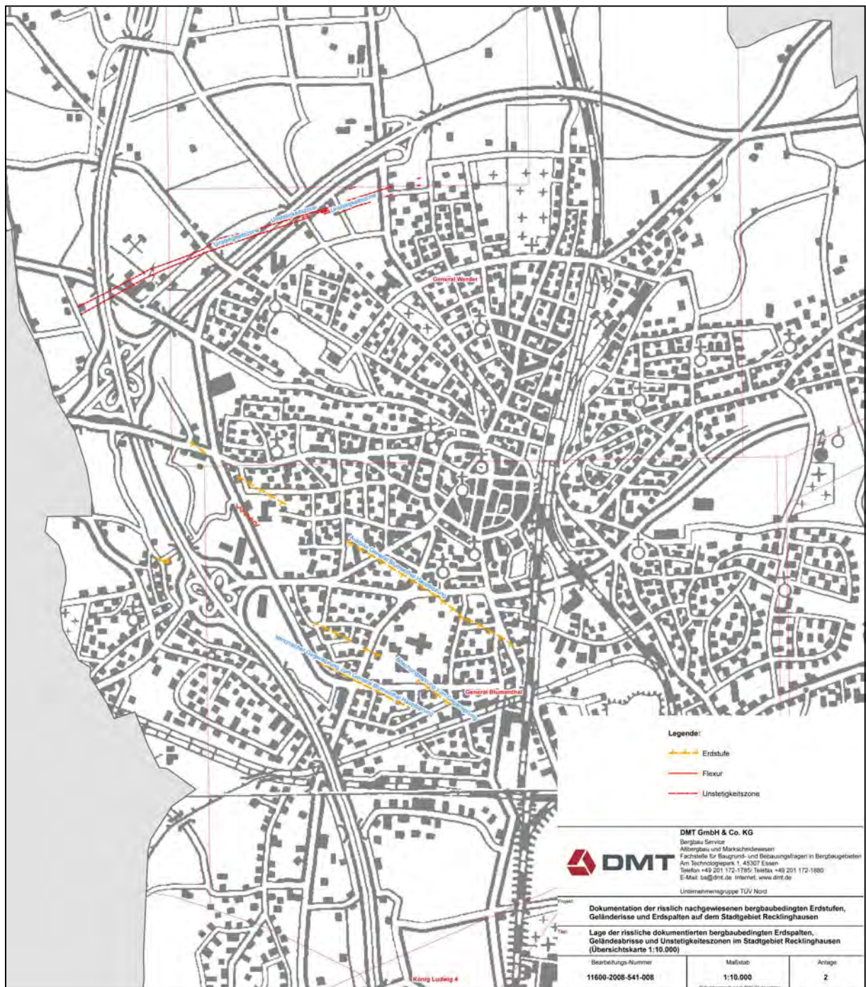
Abb. 4: Lage der risslich dokumentierten bergbaubedingten Erdspalten, Geländeerisse und Unstetigkeitszonen im Stadtgebiet von Recklinghausen (DMT 2010)
